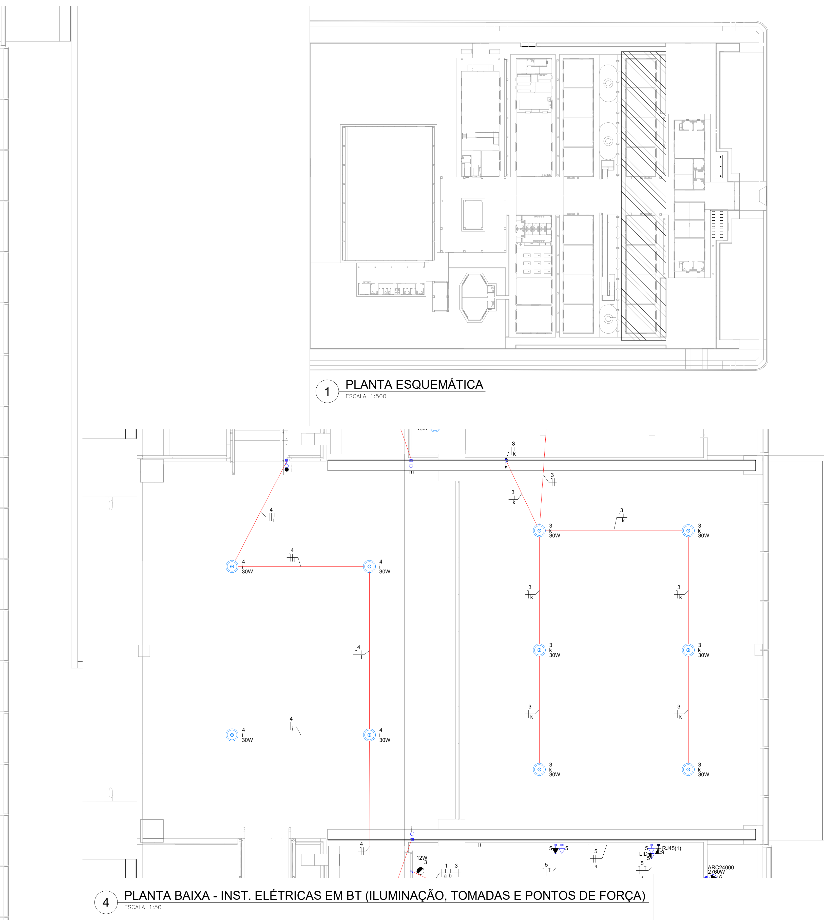
4 PLANTA BAIXA - INST. ELÉTRICAS EM BT (ILUMINAÇÃO, TOMADAS E PONTOS DE FORÇA) ESCALA 1:50
